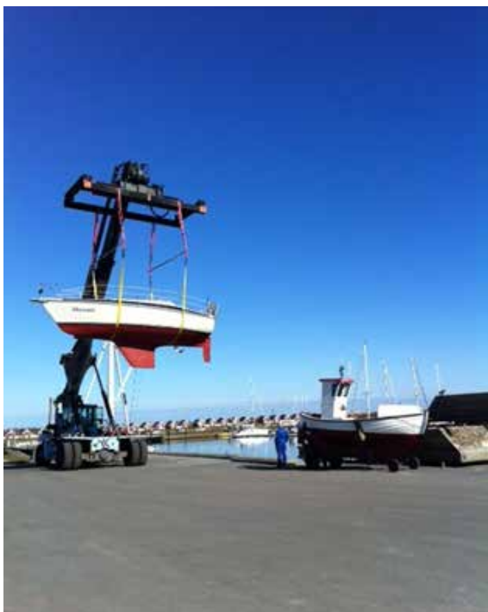
Rønnerhavnen løfter med truck uden mast
